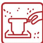
Lixar e desengraxar a superfície a ser reparada com solução desengraxante Maxi Rubber, removendo todas as impurezas.
