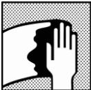
Limpeza da superfície: remover qualquer contaminação da superfície antes da aplicação do acabamento, usando um desengraxante apropriado.
