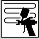
Aplicar duas a três demãos simples com flash-off de 5-10 minutos entre as demãos.
