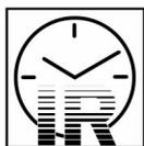
Aguardar 5 minutos de flash-off antes de curar por infravermelho. A temperatura do painel não deverá ultrapassar 100°C durante a cura. Para informações adicionais sobre cura por infravermelho; ver TDS S9.01.01
