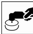
A poeira e as imperfeições menores podem ser polidas após o tempo de secagem ao ar indicado, ou após cura completa à 60°C, seguida por resfriamento para a temperatura ambiente.
