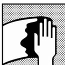
Limpeza da superfície: remova qualquer contaminação da superfície antes da aplicação do primer, utilizando um desengraxante apropriado.
