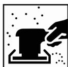
Remover a camada de tinta pré-existente e lixar bem até atingir o substrato utilizando P180 - P220 como etapa final de lixamento. *Ver TDS S8.06.02.para especificações de lixamento*
