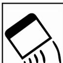
Aplicar a massa poliéster ao substrato utilizando uma espátula em um ângulo de 60°. Evitar o acúmulo de massa nas bordas da superfície à reparar rebaixando as bordas para nivelar o acabamento original.
