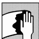
Remover qualquer contaminação da superfície utilizando um desengraxante apropriado antes do lixamento. *Para pré-limpeza da superfície utilize água morna e detergente, enxágue com água limpa.*
