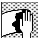
Pre-lavar a superfície com água morna e detergente e enxaguar suficientemente com água limpa. Remover contaminações de superfície com M700 ou M850.
