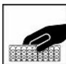
Lixar a área "C" utilizando o Sikkens Blend Prep com o auxílio de uma esponja abrasiva (3M – UFN – Cinza).
