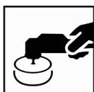
Para o acabamento final, polir completamente a área "C" com um produto abrasivo em conjunto com uma boina apropriada, preferencialmente utilizando uma máquina de polir.
