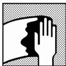
Limpeza: remova qualquer contaminação da superfície utilizando um desengraxante apropriado antes do lixamento.
